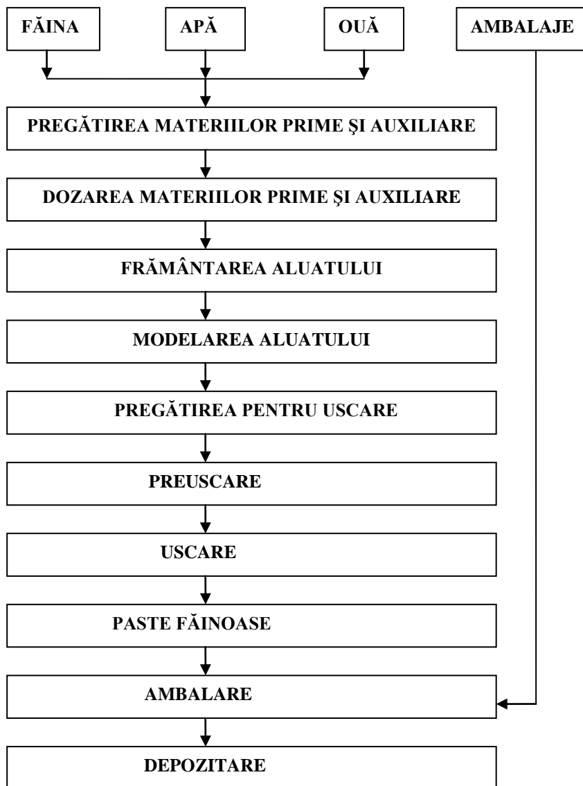
Fig. 5.11. Schema tehnologică de obținere a pastelor făinoase
