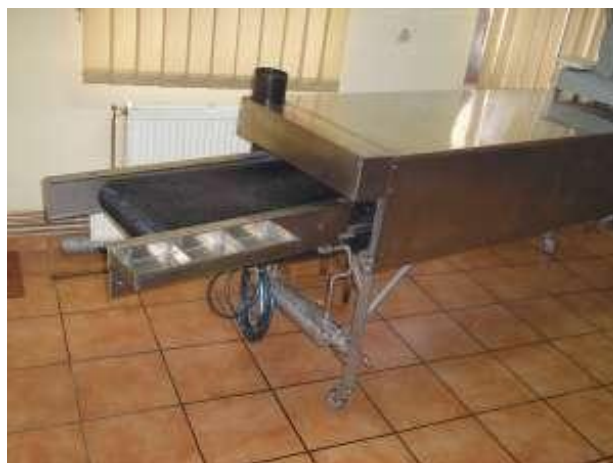
Fig.5.3 Cuptor tunel pentru covrigi
